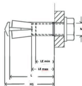
Innengewinde-Anker mit Rand aus rostfreiem Stahl für die einfache Schlagmontage
